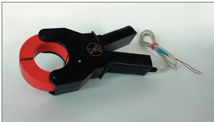
Рис. 4. Внешний вид токовых клещей без кольцевого магнитопровода для контроля токов до 10 000 А
