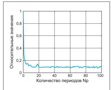
Рис. 8. Изменение амплитуды сжатого сигнала в зависимости от количества периодов
