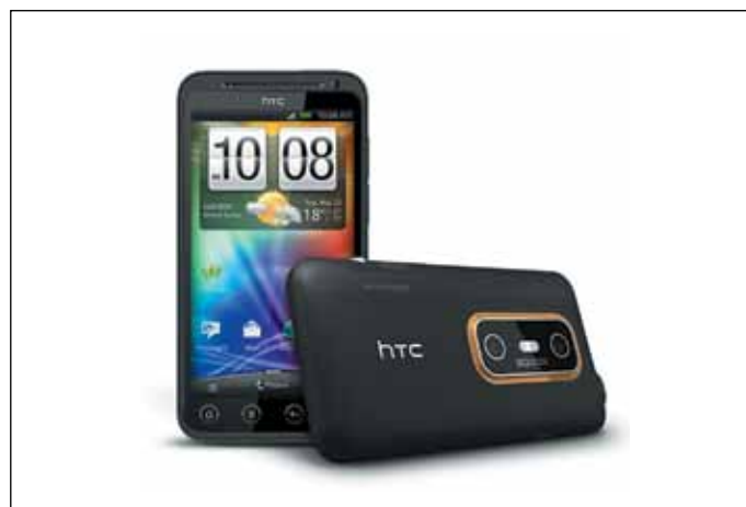
Рис. 13. Коммуникатор с автостереоскопической технологией для захвата и визуализации 3D-контента
